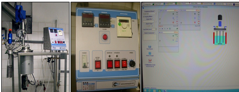
Obr. 2 Vľavo fotografia tlakového reaktora z tlakovou nádobou na plnenie vzorkami biomasy, v strede detail ovládacieho panelu reaktora, vpravo ukážka výstupu softvéru k zariadeniu.
