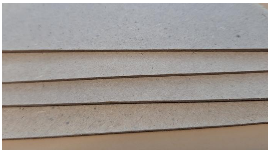
Obr. 1: Hladké lepenky z OCC s prídavkom vlákna z recyklovaných drevovláknitých materiálov
