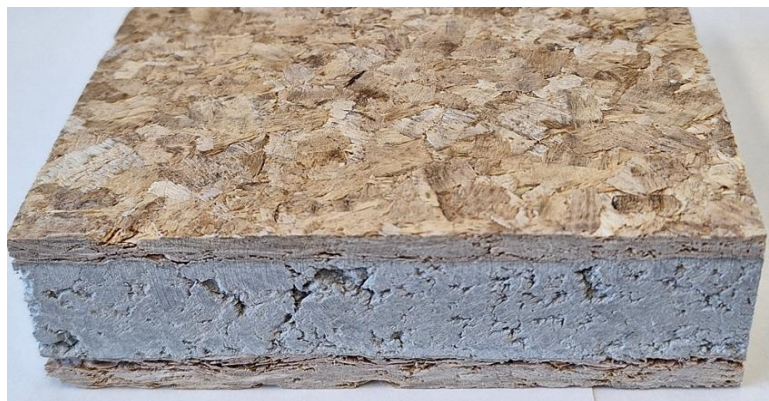
Obr. 3: Vrstvená kompozitná doska vyrobená s použitím PVAc lepidla.
