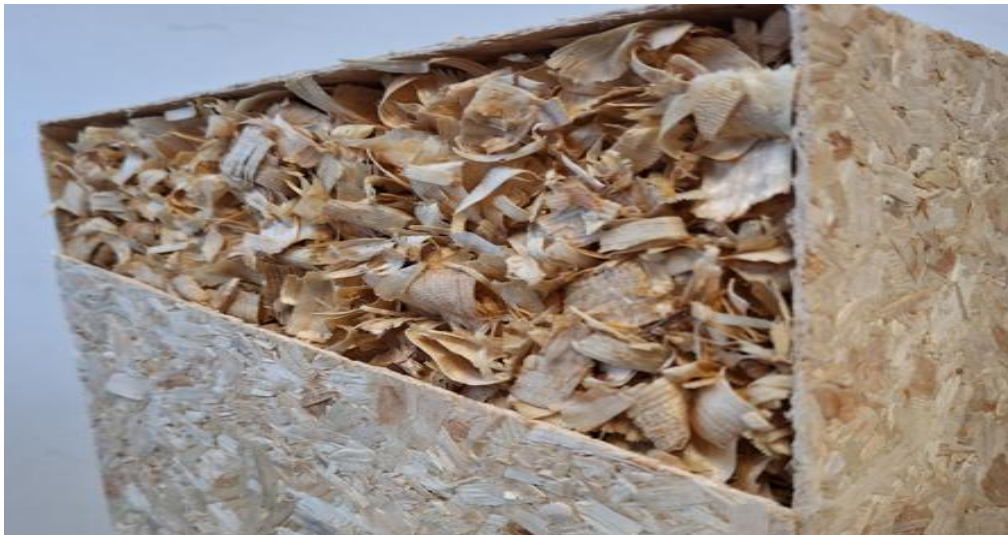
Obr. 2: Úvodný model (multá verzia bez akejkoľvek úpravy) uzatvoreného izolačného panelu 100 mm s výplňou so smrekových hoblín 50 \text{ kg/m}^3 , s opláštením hrúbky 2 mm. Pri tvorbe modelu bolo použité PVAc lepidlo
