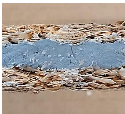
Obr. 4 a, b: Vrstvená kompozitná doska vyrobená s použitím roztoku H_2SO_4 .
