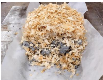
Obr. 1: Vrstvy kompozitnej dosky pred finálnym zlisovaním.
