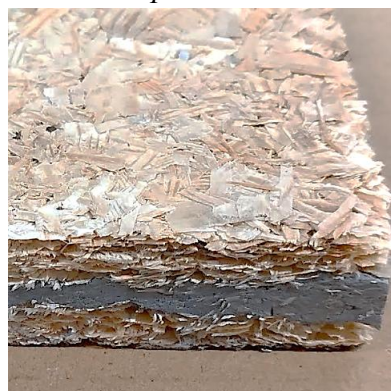
Obr. 4 a, b: Vrstvená kompozitná doska vyrobená s použitím roztoku H_2SO_4 .
